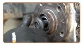
Apriete la sujeción del cubo. Use un vaso de impacto del n.º 24. Utilice una llave dinamométrica. Apriételo a un par de 200 Nm.+90°
