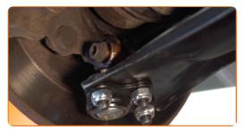
Tratar las acanaladuras de la junta homocinética del eje de transmisión. Use un cepillo de alambre. Use el aerosol WD-40.
