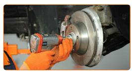
Retire el perno de sujeción.
