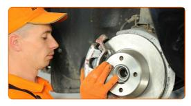
Apriete la fijación de la pinza del cáliper de freno. Use un vaso de impacto del n.º 17. Utilice una llave dinamométrica. Apriételo a un par de 125 Nm.
