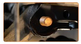
Instale el perno de sujeción.
