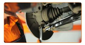
Retire el perno de sujeción.
