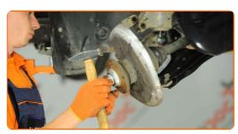
Separe el eje de transmisión de la mangueta de dirección. Use un punzón. Utilice un martillo.
