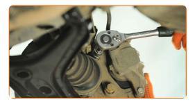
Trate las sujeciones de la rótula. Trate las sujeciones del amortiguador. Use grasa de cobre.
