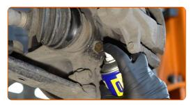
Destornille la fijación de la pinza del cáliper de freno. Use un vaso de impacto del n.º 17. Utilice una llave giramachos.
