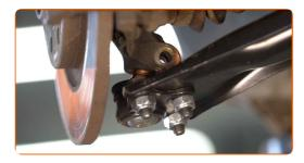
30 Instale el perno de sujeción.
