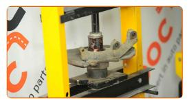
Limpie el asiento de montaje del cojinete del cubo (buje). Use un cepillo de alambre. Use el aerosol WD-40.
