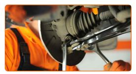
Apriete las sujeciones inferiores que conectan el amortiguador con la mangueta de dirección. Usa una llave mixta del n.º 21. Use un vaso de impacto del n.º 22. Utilice una llave dinamométrica. Apriételo a un par de 110 Nm.+90°
