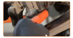
Destornille la fijación del soporte esférico del muñón de dirección. Usa una llave mixta del n.º 17. Use un vaso de impacto del n.º 17. Utilice una llave de trinquete.
