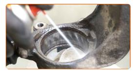
Inserte precionando el rodamiento nuevo en el muñón de dirección. Utilice un juego de cubos y rodamientos.
