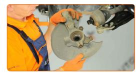
Saque el cubo de rueda del muñón de dirección. Utilice un juego de cubos y rodamientos. Utilice un martillo.
