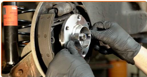
**17** Apriete la sujeción del cubo. Utilice un vaso 12 puntos nº 30. Utilice una llave dinamométrica. Apriételo a un par de 175 Nm.
