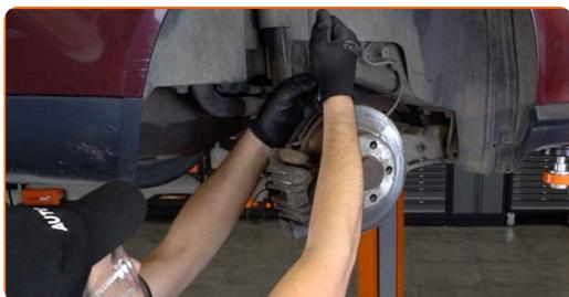
**11** Coloque un recipiente por debajo para recoger el líquido de frenos.
