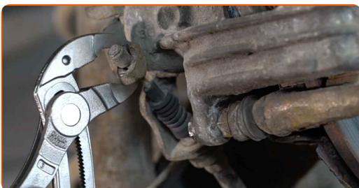
**17** Suelte el cable del freno de estacionamiento.
