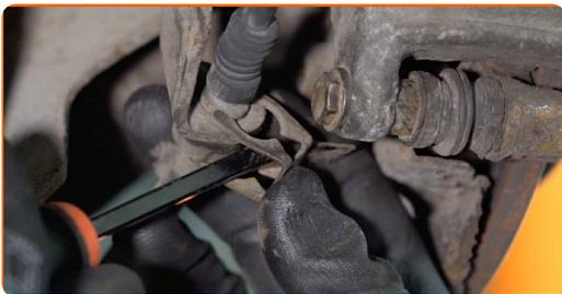
**16** Desconecte el cable del freno de estacionamiento del soporte. Use alicates de bomba de agua.
