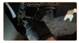
Conecte los clips de la cubierta del filtro del habitáculo.
