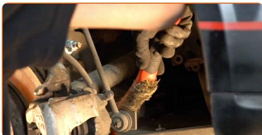
**21.1** Destornille la tuerca y quite la barra del estabilizador desde la pata amortiguadora.
