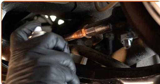
20 Trate la superficie donde el disco del freno entra en contacto con la llanta de la rueda. Use grasa de cobre.
