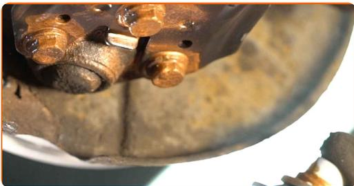
**28** Trate la superficie donde el disco del freno entra en contacto con la llanta de la rueda. Utilice grasa cerámica para altas temperaturas.
