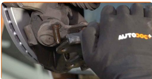
**14** Separe el eje de transmisión de la mangueta de dirección.
