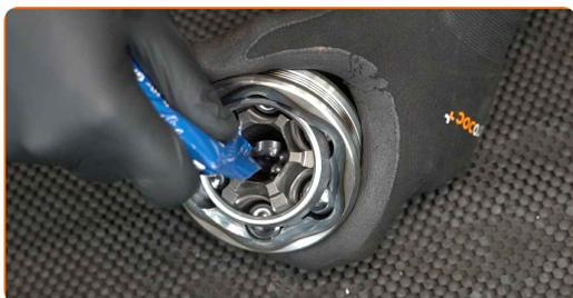
**31** Mueva el anillo interior de la nueva junta homocinética de un lado a otro para así prepararla para su funcionamiento.
