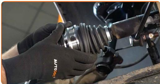
**34** Fije las abrazaderas del fuelle de la junta homocinética. Utilice un destornillador plano. Utilice alicates para abrazaderas clic-R. Utilice un martillo.
