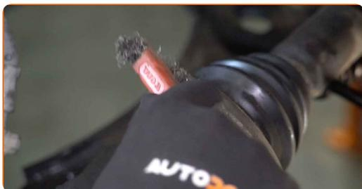
**17** Desmonte las abrazaderas del fuelle de la junta homocinética. Use una palanca.
