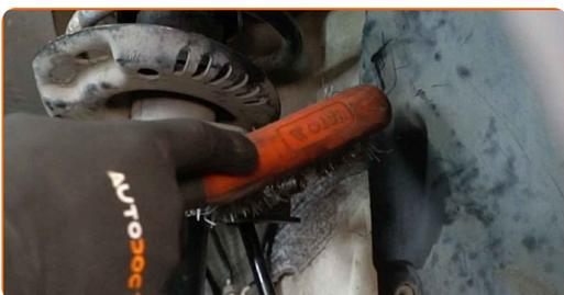
**8** Desatornille la sujeción que conecta la bieleta de barra estabilizadora al amortiguador. Use un vaso de impacto del n.º 19. Utilice una llave de trinquete.
