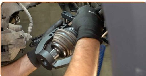
**20** Instale y apriete el perno del eje de transmisión. Use un vaso de impacto del n.º 27. Utilice una llave de trinquete.
