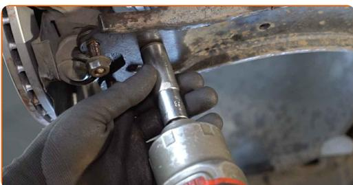
**41** Instale y apriete el perno del eje de transmisión. Use un vaso de impacto del n.º 27. Utilice una llave de trinquete.
