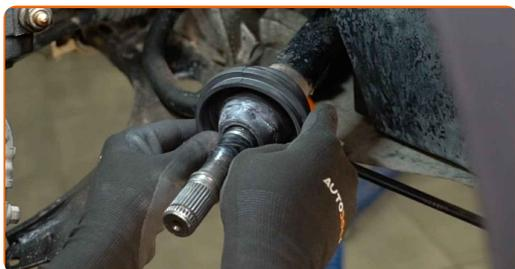
**29** Instale el anillo de seguridad de la junta homocinética.
