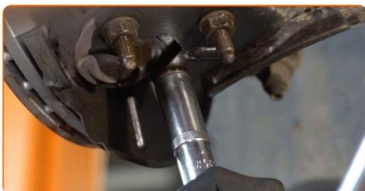
**43** Limpie los asientos de montaje de la bieleta de barra estabilizadora. Use un cepillo de alambre. Use el aerosol WD-40.
