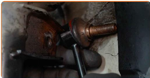
**10** Retire el perno de sujeción.
