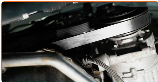
**10** Vuelva a colocar la polea tensora en su posición inicial. Usa una llave mixta del n.º 16.
