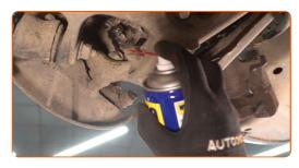
Destornille la fijación de la pinza del cáliper de freno. Use Vaso HEX No. H8.
