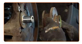
Limpie el asiento de montaje del cojinete del cubo (buje). Utilice un spray de limpieza multiuso.
