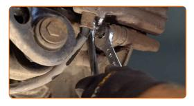
Retire el soporte de freno. Use una palanca.
