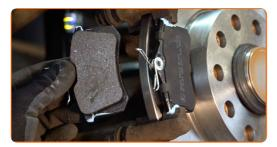
Establezcan el soporte de freno y lo fijen. Use un vaso de impacto del n.º 13. Usa una llave mixta del n.º 15. Utilice una llave dinamométrica. Apriételo a un par de 35 Nm.
