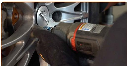
**31** Baje el automóvil y, manteniendo el orden cruzado, apriete los pernos de fijación de las ruedas. Utilice una llave dinamométrica. Apriételo a un par de 120 Nm.
