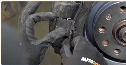
**33** Conecte el captador de desgaste de las pastillas de freno.
