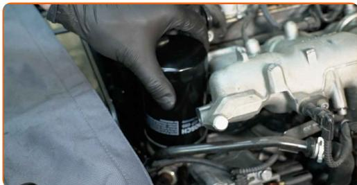
**16** Atornille el filtro nuevo en su sitio. Utilice el vaso 76-14F. Utilice una llave dinamométrica. Apriételo a un par de 18 Nm.
