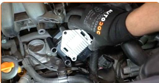
**10** Apriete los pernos de la bobina de encendido. Use Vaso HEX No. H5. Utilice una llave dinamométrica. Apriételo a un par de 7 Nm.
