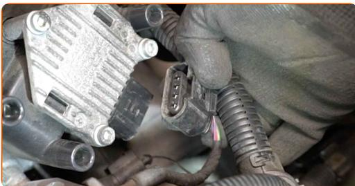
**7** Desenrosque los pernos de la bobina de encendido. Use Vaso HEX No. H5. Utilice una llave de trinquete.
