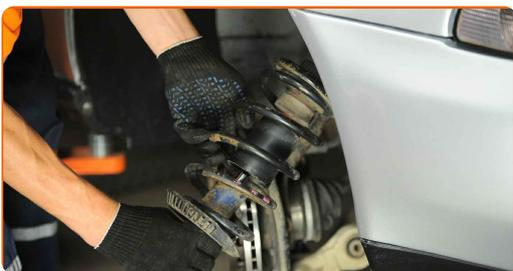
29 Fije las sujeciones superiores del puntal amortiguador.
