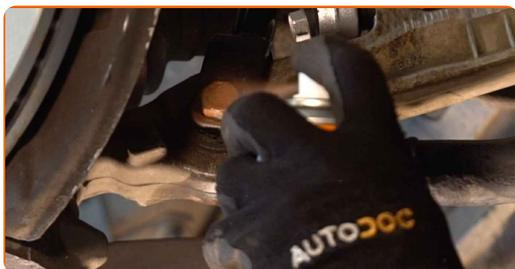
**45** Trate la superficie donde el disco del freno entra en contacto con la llanta de la rueda. Use grasa de cobre.
