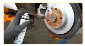
Limpie el asiento de montaje de la llanta de la rueda. Use un limpiador de frenos.
