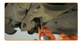
Apriete la sujeción que conecta la bieleta a la barra estabilizadora. Usa una llave mixta del n.º 16. Usa una llave mixta del n.º 18. Utilice una llave dinamométrica. Apriételo a un par de 45 Nm.
