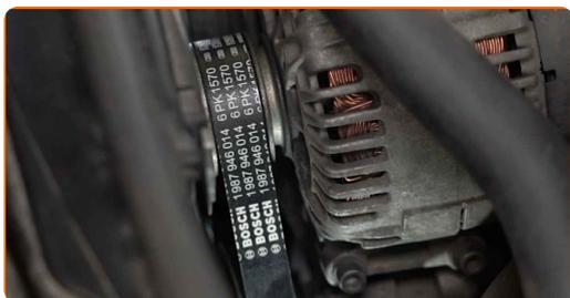
**11** Pongan en marcha el motor por unos minutos. Esto es necesario para asegurarse de que el componente funciona correctamente.
