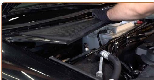
**4** Utilice un protector de aletas para evitar daños en la pintura y en las partes de plástico del automóvil.
