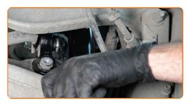
Retire el enlace estabilizador de estabilidad transversal.
