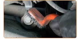
Desenrosque la sujeción que conecta la barra estabilizadora con el brazo de control. Use un vaso de impacto del n.º 16. Utilice una llave de trinquete.
