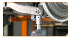
Apriete la sujeción que conecta la barra estabilizadora con el brazo de control. Usa una llave mixta del n.º 16. Use un vaso de impacto del n.º 16. Utilice una llave dinamométrica. Apriételo a un par de 40 Nm.+90°
