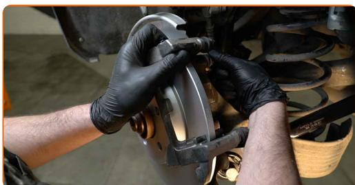
**25** Apriete la fijación de la pinza del cáliper de freno. Use un vaso de impacto del n.º 18. Utilice una llave dinamométrica. Apriételo a un par de 100 Nm.+90°
