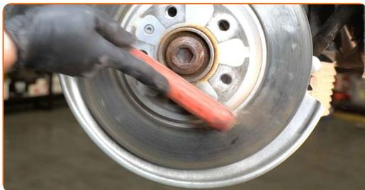
**17** Destornille la fijación del disco de freno. Utilice Torx T30. Utilice un destornillador de impacto.
