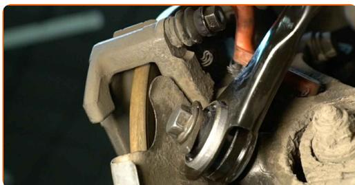
**14** Destornille la fijación de la pinza del cáliper de freno. Usa una llave mixta del n.º 18.
