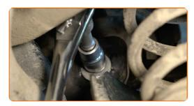
Apriete la fijación de la palanca al bastidor auxiliar. Use un vaso de impacto del n.º 18. Utilice una llave dinamométrica. Apriételo a un par de 70 Nm.+180°
