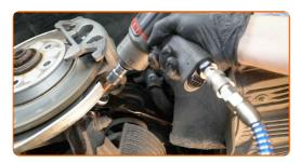
Atornille la sujeción que conecta el brazo de control al subchasis. Usa una llave mixta del n.º 18. Use un vaso de impacto del n.º 18. Utilice una llave de trinquete.
