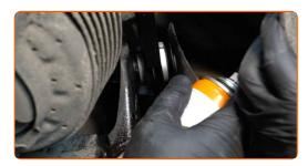
Apriete la sujeción que conecta el brazo de suspensión a la mangueta trasera. Use un vaso de impacto del n.º 18. Utilice una llave dinamométrica. Apriételo a un par de 95 Nm.
