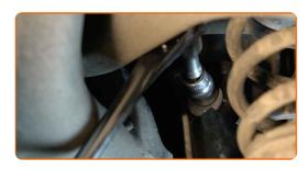
Desatornille la sujeción que conecta el brazo de control a la mangueta trasera. Use un vaso de impacto del n.º 18. Utilice una llave de trinquete.
