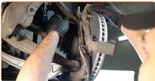
**24** Apriete la fijación de la pinza del cáliper de freno. Use un vaso de impacto del n.º 21. Utilice una llave dinamométrica. Apriételo a un par de 196 Nm.
