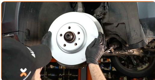
**21** Apriete la fijación del disco de freno. Utilice Torx T30. Utilice una llave dinamométrica. Apriételo a un par de 5 Nm.
