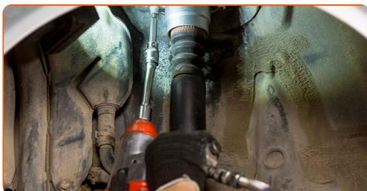
**24** Atornille la sujecion inferior del amortiguador. Usa una llave mixta del n.º 21. Use un vaso de impacto del n.º 21. Utilice una llave de trinquete.
