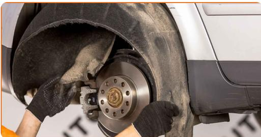
**12** Destornille la fijación superior del amortiguador. Use Vaso HEX No. H6. Utilice una llave de trinquete.
