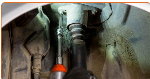
**23** Instale el perno de sujeción.
