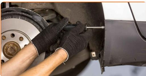
**11** Retire la cubierta del paso de rueda.
