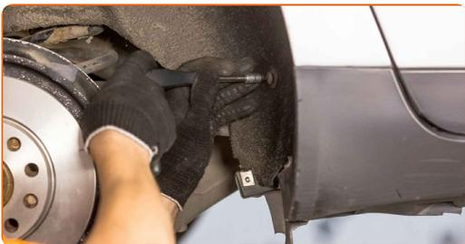
**29** Trate la superficie donde el disco del freno entra en contacto con la llanta de la rueda. Use grasa de cobre.
