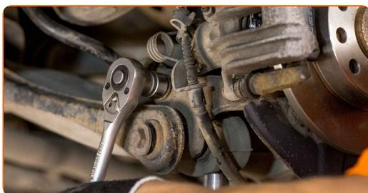
**25** Apriete la fijación inferior del amortiguador. Use un vaso de impacto del n.º 21. Utilice una llave dinamométrica. Apriételo a un par de 150 Nm.+90°
