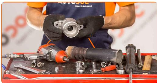
**19** Atornille la fijación superior de la varilla del amortiguador. Use una llave mixta del n.º 17. Use una llave ajustable. Utilice una llave dinamométrica. Apriételo a un par de 25 Nm.
