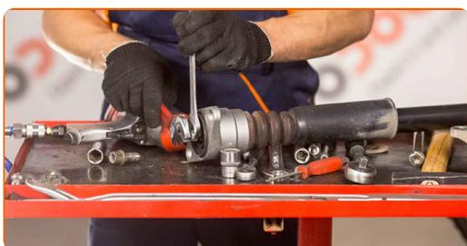
**20** Limpie los asientos de montaje del amortiguador. Use un cepillo de alambre. Use el aerosol WD-40.
