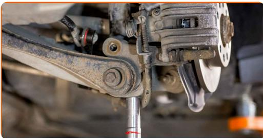
**9** Retire el perno de sujeción.
