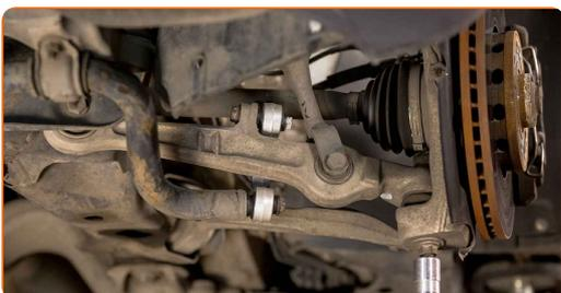
**16** Apriete la sujeción que conecta la bieleta a la barra estabilizadora. Usa una llave mixta del n.º 16. Utilice una llave dinamométrica. Apriételo a un par de 40 Nm.+90°
