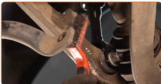
**12** Instale la barra del estabilizador de estabilidad transversal.
