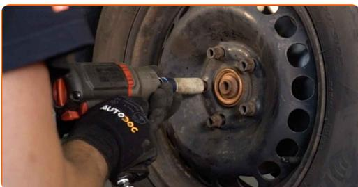
**19** Baje el automóvil y, manteniendo el orden cruzado, apriete los pernos de fijación de las ruedas. Utilice una llave dinamométrica. Apriételo a un par de 120 Nm.
