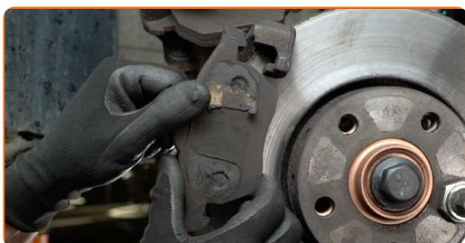
**15** Limpie la pinza del cáliper de freno de polvo y suciedad. Use un cepillo de alambre. Use el aerosol WD-40.
