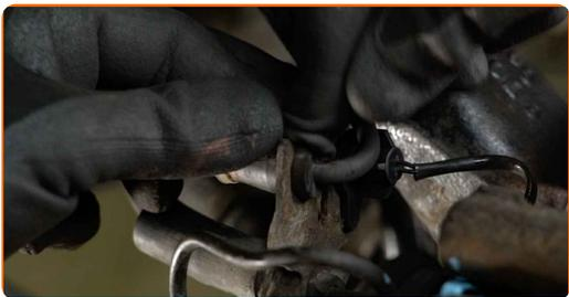
**31** Instale el resorte de fijación del cáliper de freno.
