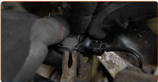
**30** Conecte la clavija del sensor de desgaste de las pastillas de freno.
