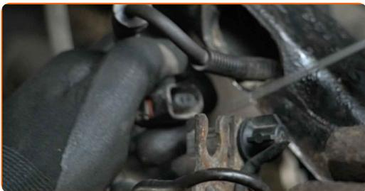
**11** Desconecte el captador de desgaste de las pastillas de freno. Use una palanca.
