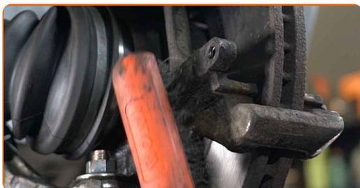
**16** Destornille la fijación de la pinza del cáliper de freno. Use un vaso de impacto del n.º 17. Utilice una llave giramachos. Utilice una llave de trinquete.
