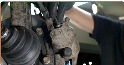
**29** Conecte el captador de desgaste de las pastillas de freno.
