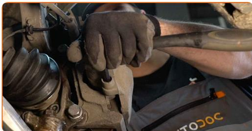
**11** Separe el muelle de retención de la pinza de freno. Use una palanca.
