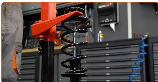
**39** Instale el guardapolvo y el tope en el amortiguador nuevo.
