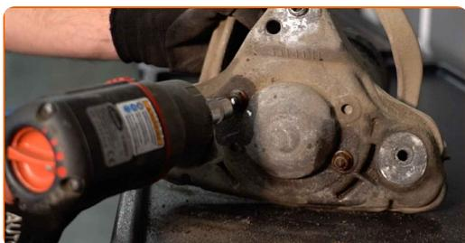
**28** Retire el soporte superior del amortiguador que se encuentra montado con los brazos de control.
