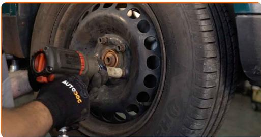
**70** Baje el automóvil y, manteniendo el orden cruzado, apriete los pernos de fijación de las ruedas. Utilice una llave dinamométrica. Apriételo a un par de 120 Nm.
