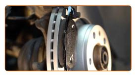
Establezcan el soporte de freno y lo fijen. Use Vaso HEX No. H7. Utilice una llave dinamométrica. Apriételo a un par de 30 Nm.
