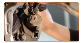
Conecte el captador de desgaste de las pastillas de freno.
