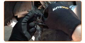
Instale el resorte de fijación del cáliper de freno. Use una palanca.
