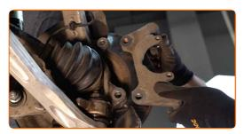
Destornille la fijación del disco de freno. Utilice Torx T30. Utilice una llave de trinquete.
