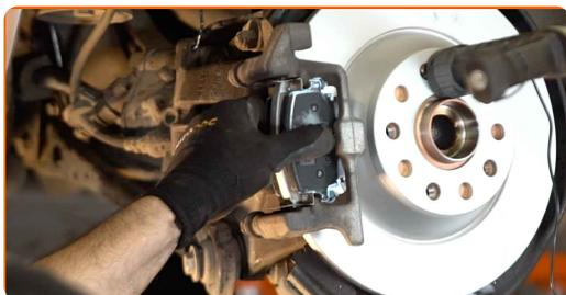
**26** Establezcan el soporte de freno y lo fijen. Use un vaso de impacto del n.º 13. Use una llave mixta del n.º 15. Utilice una llave dinamométrica. Apriételo a un par de 35 Nm.
