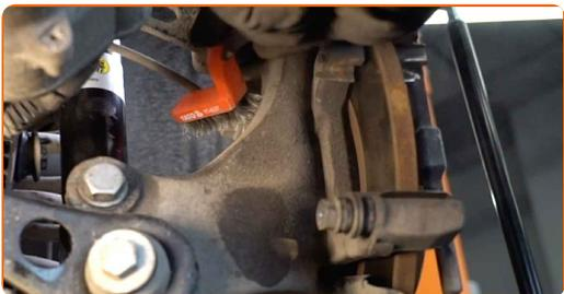
**12** Destornille la fijación de la pinza del cáliper de freno. Usa una llave mixta del n.º 17.
