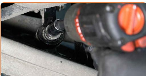
**8** Afloje los sujeciones que conectan la bieleta de barra estabilizadora. Usa una llave mixta del n.º 16 (2 piezas).
