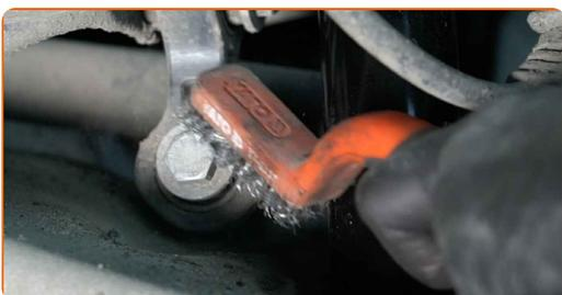
**7** Desenrosque la sujeción que conecta la barra estabilizadora con el brazo de control. Use un vaso de impacto del n.º 16. Utilice una llave de trinquete.
