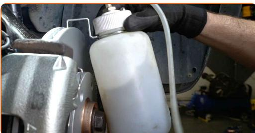
**36** Afloje el tornillo de purgado de frenos. Usa una llave mixta del n.º 10.
