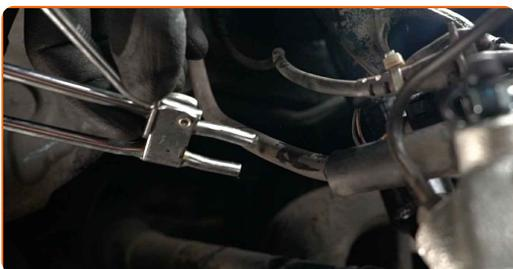
**35** Conecte la manguera del kit de purgado de frenos al tornillo de purgado de freno.
