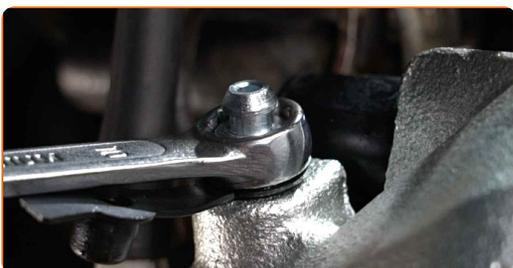
**37** Deje salir el aire del sistema del cáliper de freno. Sin poner el motor en marcha, empuje algunas veces el pedal del freno hasta el final, hasta que se note una resistencia considerable.
