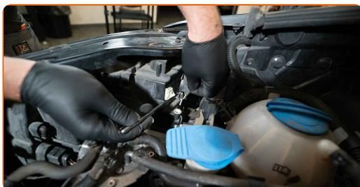
**3** Desconecte el portalámparas girándolo unos ~ 30°. Retire el portalámparas del asiento de montaje del faro delantero.
