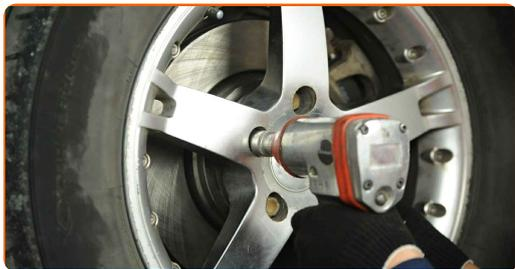
**27** Baje el automóvil y, manteniendo el orden cruzado, apriete los pernos de fijación de las ruedas. Utilice una llave de impacto para llanta # 19. Utilice una llave dinamométrica. Apriételo a un par de 180 Nm.
