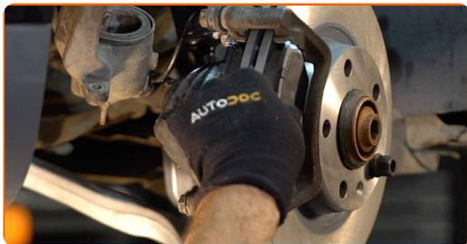
**27** Establezcan el soporte de freno y lo fijen. Usa una llave mixta del n.º 13. Usa una llave mixta del n.º 15. Utilice una llave dinamométrica. Apriételo a un par de 30 Nm.
