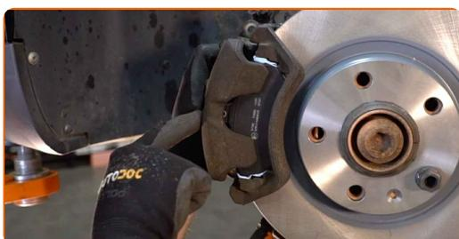
**28** Conecte el captador de desgaste de las pastillas de freno.
