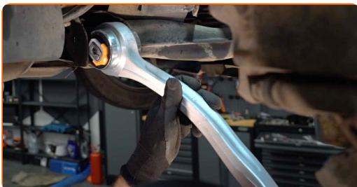
Sustitución: brazo inferior de la parte delantera - AUDI Allroad C5 (4BH).
