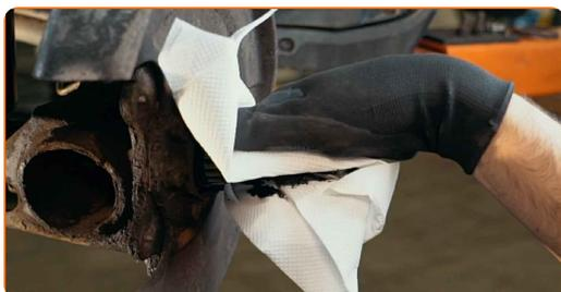
**19** Limpie el asiento de montaje del cojinete del cubo (buje). Use un cepillo de alambre. Use el aerosol WD-40.
