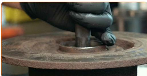
**21** Retire el anillo interior del cojinete del cubo de rueda. Retire el sello de aceite interior del cojinete de la rueda. Utilice un extractor universal. Utilice el extractor de cubos de rueda con martillo deslizante.
