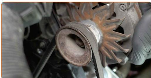
**32** Apriete las sujeciones del alternador. Use un vaso de impacto del n.º 13. Utilice una llave dinamométrica. Apriételo a un par de 10 Nm.
