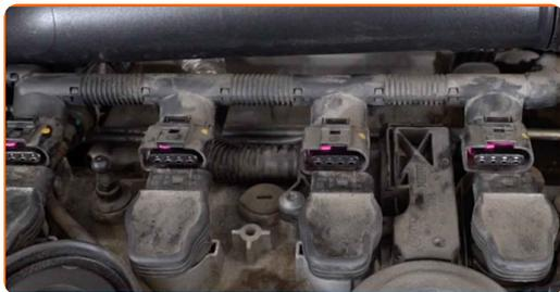
**6** Levante la bobina de ignición haciendo palanca. Use una palanca.
