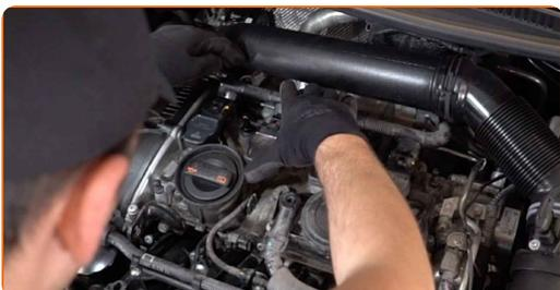
**12** Asegure el cableado de las bobinas del encendido en sus asientos de montaje.
