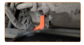
Destornille el tapón de desagüe. Use un vaso de impacto del n.º 19. Utilice una llave de trinquete.
