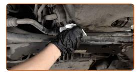
Atornille en el nuevo tapón de drenaje y apriételo. Use un vaso de impacto del n.º 19. Utilice una llave dinamométrica. Apriételo a un par de 26 Nm.
