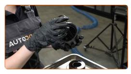
Instale el nuevo filtro de aceite en el asiento de montaje de la cubierta del filtro.
