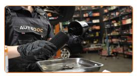
Retire la junta tórica de la tapa del filtro de aceite. Utilice un destornillador plano.
