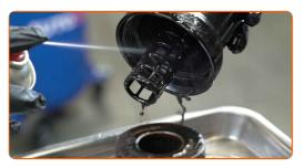
Instale una nueva junta tórica en el asiento de montaje de la cubierta del filtro.
