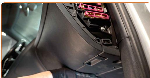
**14** Atornille los tornillos de fijación de la guantera. Use un vaso de impacto del n.º 8. Utilice una llave de trinquete.
