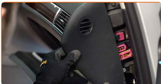
**5** Destornille los tornillos de fijación de la guantera. Use un vaso de impacto del n.º 8. Utilice una llave de trinquete.
