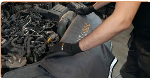
**3** Afloje los tornillos de sujeción de la cubierta del filtro de aire. Utilice Torx T25. Utilice una llave de trinquete.
