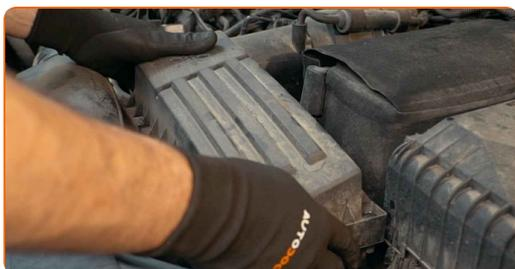
**12** Atornille los tornillos de sujeción de la cubierta del filtro de aire. Utilice Torx T25. Utilice una llave de trinquete.
