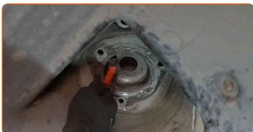
**47** Instale la pata amortiguadora en el arco de la rueda.
