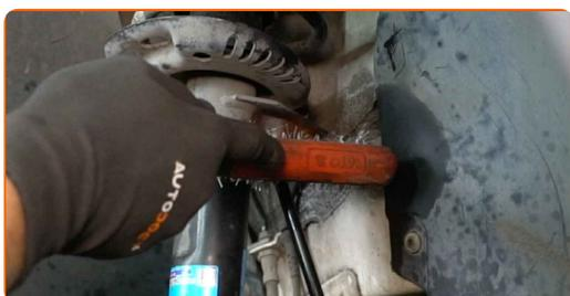
**16** Desatornille la sujeción que conecta la bieleta de barra estabilizadora al amortiguador. Use un vaso de impacto del n.º 19. Utilice una llave de trinquete.
