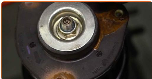
**45** Retire el puntal amortiguador que está montado.
