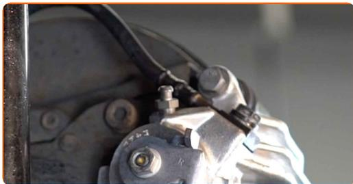
**24** Afloje el tornillo de purgado de frenos. Usa una llave mixta del n.º 11.
