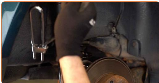
**23** Separe la tapa del tornillo de purga de la pinza de freno.
