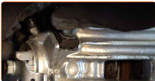
**21** Apriete la sujeción que conecta el tubo de freno a la pinza de freno. Use un vaso de impacto del n.º 13. Utilice una llave dinamométrica. Apriételo a un par de 35 Nm.
