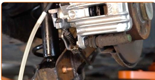
**27** Fije el cable del freno de estacionamiento mediante el clip de sujeción.
