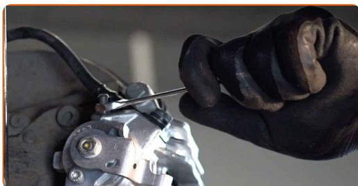
**25** Conecte la manguera del kit de purgado de frenos al tornillo de purgado de freno.
