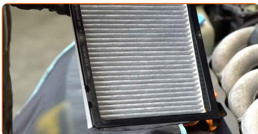
**8** Inserte en la carcasa del filtro el nuevo elemento filtrante. Asegúrese de que el borde del filtro encaje firmemente en la carcasa.
