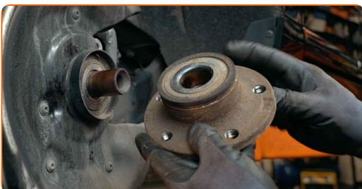
**23** Limpie el asiento de montaje del cojinete del cubo (buje). Use un cepillo de alambre. Utilice un spray de limpieza multiuso.
