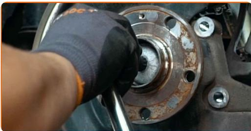
**21** Retire el perno de sujeción.
