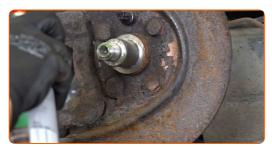
Aplique grasa especial al asiento de montaje del ensamblaje del cojinete.
