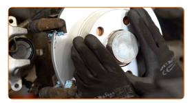
Apriete la fijación del disco de freno. Utilice Torx T30. Utilice una llave dinamométrica. Apriételo a un par de 4 Nm.
