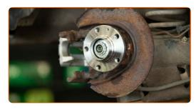
Apriete la sujeción del cubo. ¡Importante! Asegúrese de utilizar elementos de sujeción nuevos. Utilice un vaso de 12 puntos # 32. Utilice una llave dinamométrica. Apriételo a un par de 70 Nm.+45°
