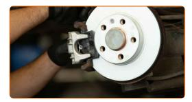
Apriete la fijación de la pinza del cáliper de freno. Usa una llave mixta del n.º 15. Use un vaso de impacto del n.º 13. Utilice una llave dinamométrica. Apriételo a un par de 35 Nm.
