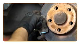
Destornille los tornillos de fijación del disco de freno y quítelo. Utilice Torx T30.
