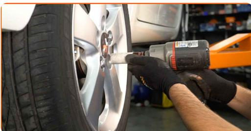
**24** Baje el automóvil y, manteniendo el orden cruzado, apriete los pernos de fijación de las ruedas. Utilice una llave dinamométrica. Apriételo a un par de 103 Nm.
