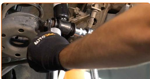
**27** Retire el soporte por debajo de la viga trasera.
