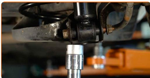
**21** Apriete la fijación inferior del amortiguador. Usa una llave mixta del n.º 17. Use un vaso de impacto del n.º 17. Utilice una llave dinamométrica. Apriételo a un par de 75 Nm.
