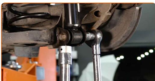
**22** Retire el soporte por debajo de la viga trasera.
