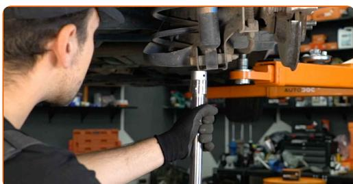
**24** Instale el perno de sujeción.
