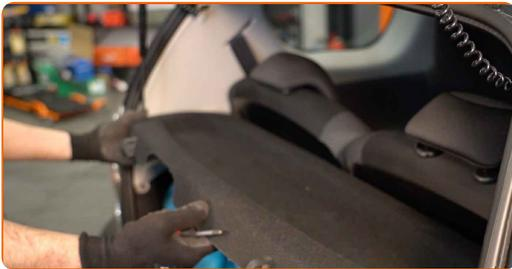
16 Compruebe el estado de funcionamiento de los muelles de gas del maletero después de haberlos instalado.
