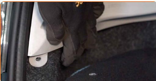
14 Atornille las sujeciones del revestimiento de la parte lateral del maletero. Utilice un destornillador Phillips.
